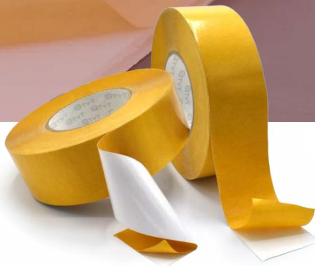
Ruban adhésif de double face composé d'un support en PVC de 80 µm, recouvert sur ses deux côtés d'un adhésif polyacrylique modifié et protégé sur sa face supérieure par un liner bi-siliconé jaune de 90 g/m<sup>2</sup>.
