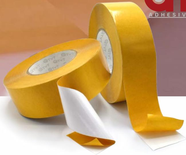
Cinta adhesiva de doble cara compuesta por un soporte de PVC de 80  $\mu\text{m}$ , recubierto en ambas caras por un adhesivo poliacrílico modificado y protegido en su cara superior por un liner bisiliconado de color amarillo de 90  $\text{g}/\text{m}^2$ .
