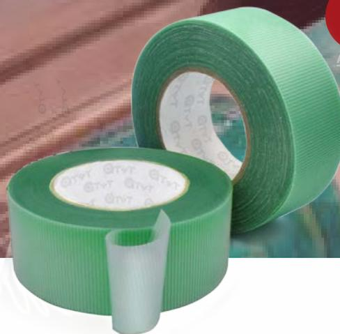
Ruban adhésif de double face avec un support rigide en PVC de 200 µm d'épaisseur conçu pour le montage de plaques de photopolymères, constitué d'un support en PVC rigide transparent, recouvert sur ces deux cotés d'un adhésif en caoutchouc solvant et protégé par un liner en PVC vert gaufré.
